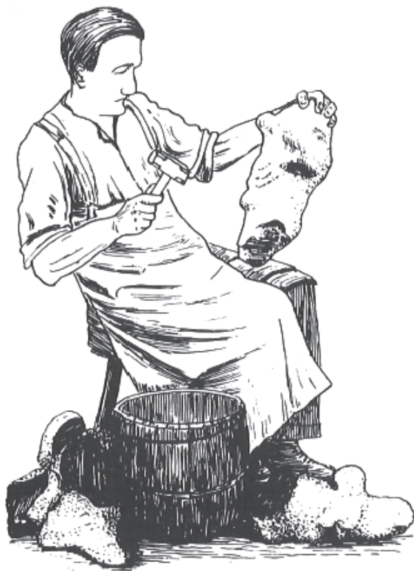
Ryc. 4. Dzielenie konkracji; za Bernes Alfred S.: L'Industrie des pierres à fusil par la méthode anglaise et son rapport avec le coup de burin tardenoisien . „Bulletin de la Société préhistorique de France” 1937, Vol. 34, cahier 7–8, p. 329, fig. 1
