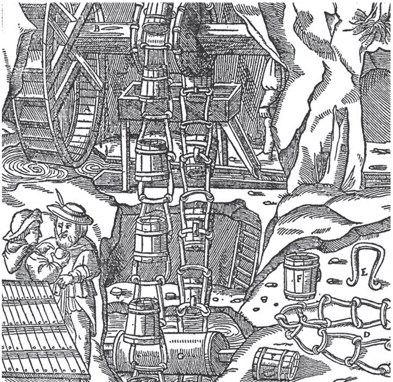
Ryc. 4. Przykład konstrukcji łańcuchowego mechanizmu do pompowania wody wyposażonego w drewniane kubły; reprod. za: Agricola G.: De re metallica libri XII . London 1912, s. 175
