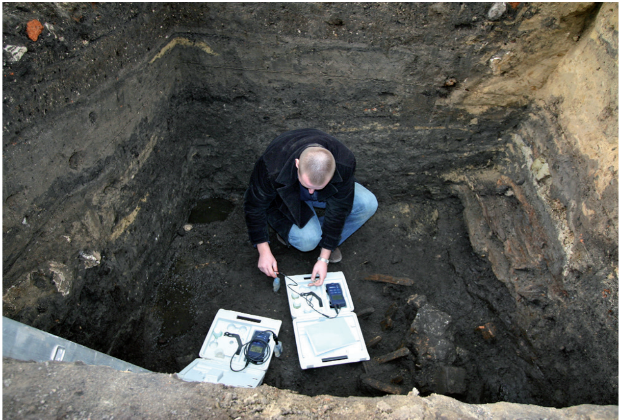
Ryc. 6. Pobór próbki wody wysączającej się do wkopu na Małym Rynku; fot. M. Wardas; 2007 r.
