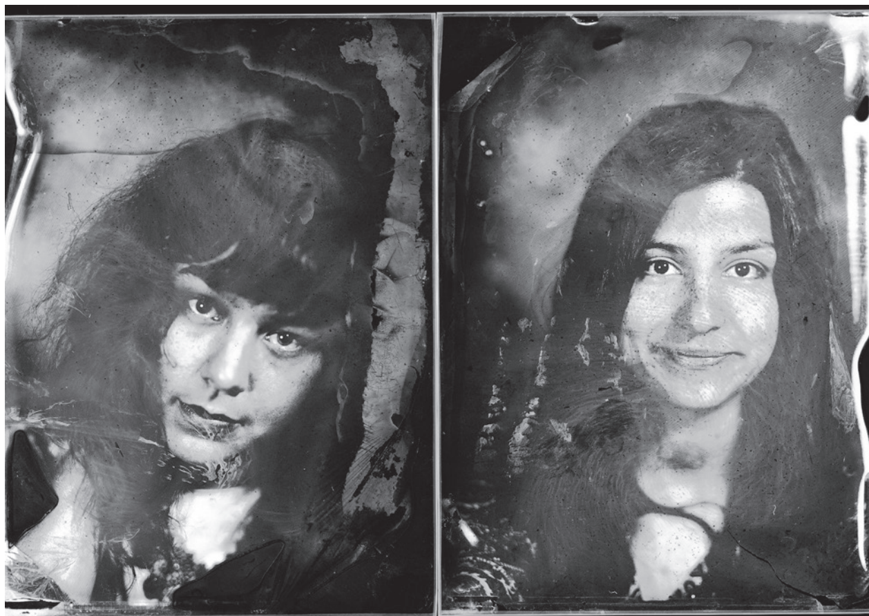
Negatywy w technice mokrej płyty kolodionowej – widoczne odspojenia warstwy obrazowej, fot. Karina Niedzielska
