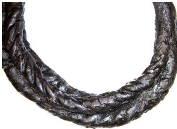
Ryc. 1b. Obraz makroskopowy pierścienia, powiększenie 6,7-krotne; fot. A. Garbacz-Klempka
