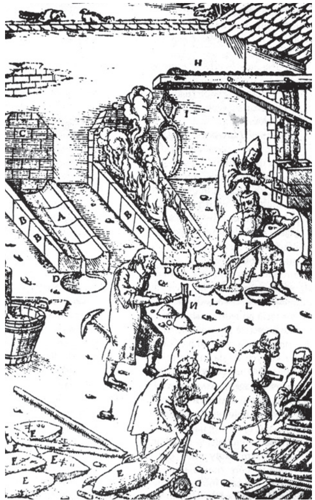
Ryc. 2. Wytapianie ołowiu i formowanie bochnów (według: Agricola G.: De re metallica libri XII . Basileae 1556)
