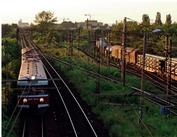
Miejsce styku linii Kraków Główny – Przemyśl (z lewej) oraz kolei obwodowej Łobzów – Prokocim Towarowy (z prawej) w rejonie północnej głowicy dworca płażowskiego. Czytelny rozdział ruchu pasażerskiego od towarowego: Zespół trakcyjny EN 57 jako pociąg osobowy relacji Kraków Główny – Stróże oraz skład towarowy wyjeżdżający z Prokocimia na kolej obwodową, fot. D. Lulewicz, 2009
